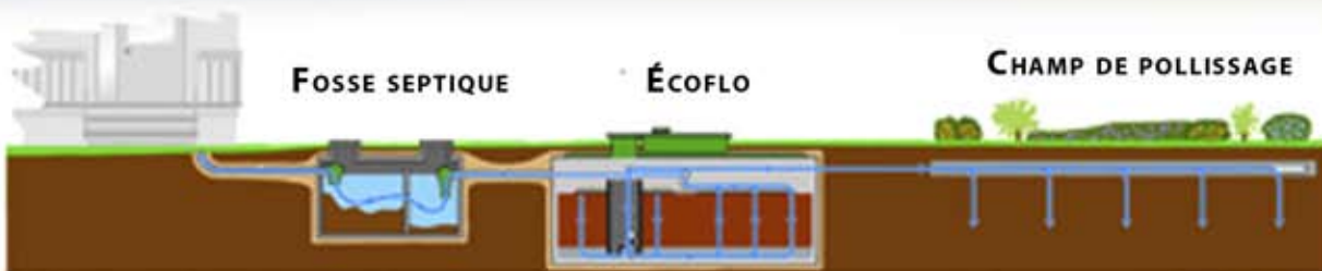
Système complet Ecoflo de traitement des eaux usées résidentielles
